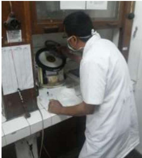
Pemurnian Senyawa dengan Kromatografi Radial (Kromatotron) di Laboratorium Kimia Organik Bahan alam ITB
